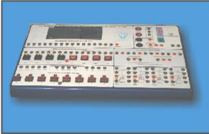
**DESCRIPCIÓN:** Este aparato es ideal para realizar experimentos y prácticas de Control Lógico Programable (PLC). Es útil en los laboratorios de Electrónica, Electromecánica, Eléctrica, Mecánica e Industrial de nivel Medio Superior y Superior.
